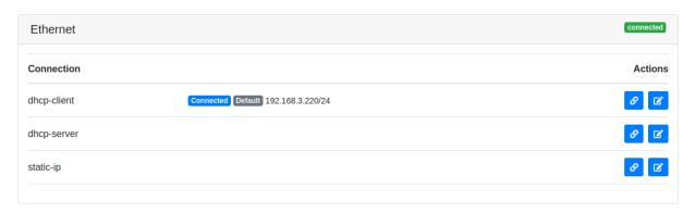
**Static-ip 模式**:如果 VRTK2 传感器通过路由器接入客户主机(主机处于相同路由器 IP 段内),同时客户希望 VRTK2 传感器 IP 地址固定,可根据路由器配置设为同主机 IP 地址段内任一固定 IP。VRTK2 传感器通过路由器连接互联网(路由器已联网)。
